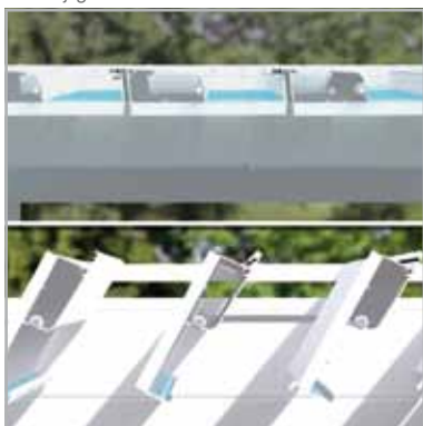
Gecontroleerde waterafvoer ook bij opendraaiende lamel
